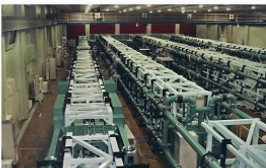
Рис. 1. Лазерная установка на стекле с неодимом для исследования в области термоядерного синтеза.
