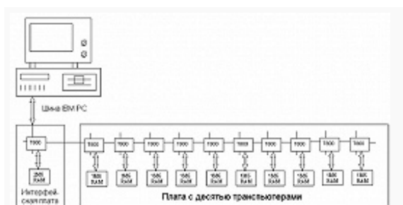
Рис. 5. Архитектура транспьютерного рабочего места с одной или несколькими десяти транспьютерными платами.
