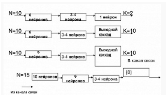
Рис. 4. Функциональная структура четырёхслойного нейрокомпьютера: N – размерность входного вектора; K – число распознаваемых образов.
