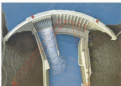
Рис. 2. Арочно-гравитационная бетонная плотина Саяно-Шушенской ГЭС.
