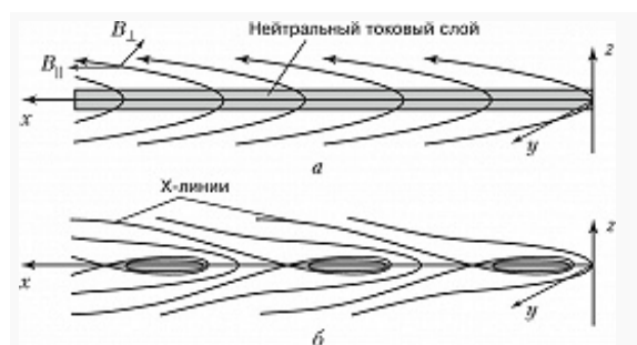
Рис. 2. Нейтральный токовый слой (серые области) с конечной нормальной компонентой магнитного поля B_{\perp} : а – в отсутствие возмущения; б – после образования «магнитных островов».
