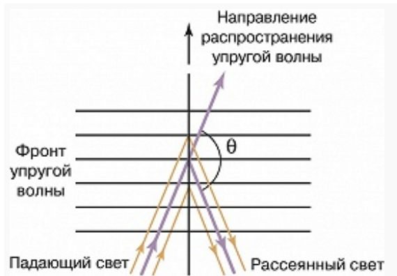
Рис. 1. Рассеяние света на упругой волне.
