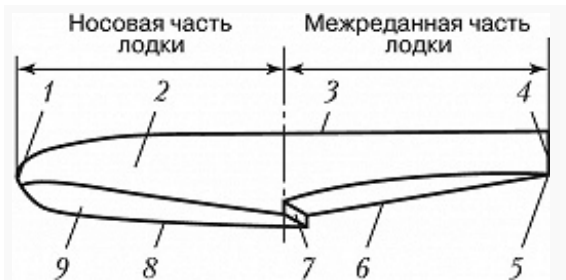
Рис. 1. Характерные обводы летающей лодки: 1 – нос; 2 – борт; 3 – палуба; 4 – корма; 5 и 7 – поперечные реданы; 6 – межреданная часть днища; 8 – киль; 9 &ndash...
